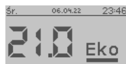
Rys. nr 6 Zadajnik Standard - ekran główny (zadawanie temperatury)
