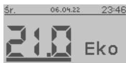
Rys. nr 7 Zadajnik Standard - ekran główny (wybór trybu pracy)
