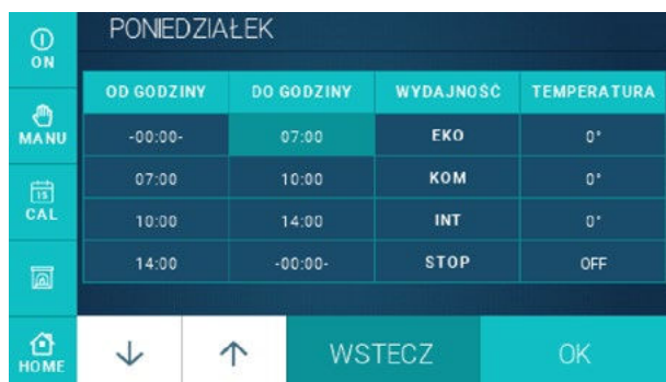
Rys. nr 40 Ustawianie kalendarza zadajnika ADVANCE
